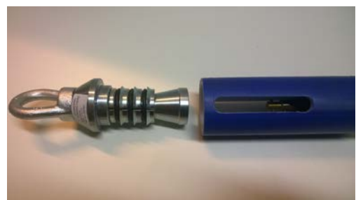
(Billede viser) ”Multi prop” monteret og trækhead
